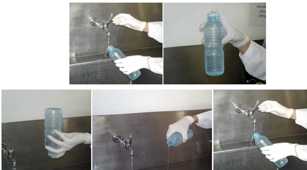
Figura 11. Procedimento de coleta de água para a análise organoléptica
