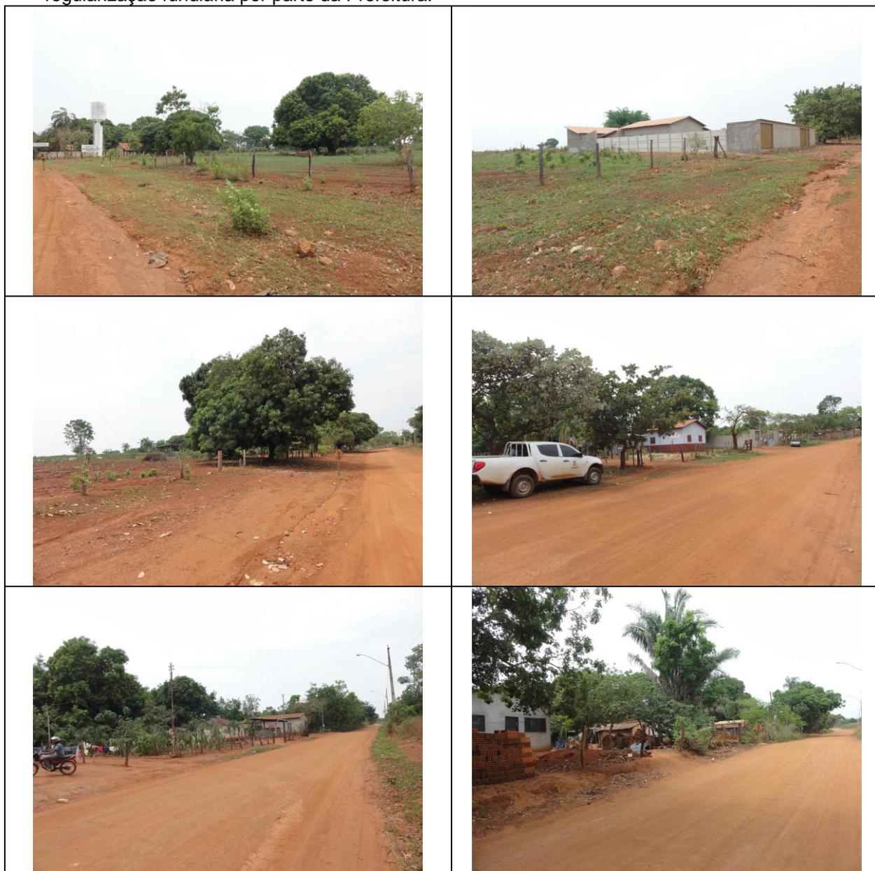
**Figura 01** – Área onde o eixo da rodovia projetada coincide com o eixo da estrada existente. Entre a margem esquerda e direita da atual estrada possui uma faixa livre de edificações com largura mínima de 16 m. No lado esquerdo a área é de propriedade da prefeitura de Palmeirópolis e já se encontra fracionada onde pode ser observada a presença de lotes com e sem edificações.
