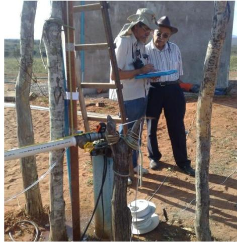
Figura 12.3 – Detalhe do tubo de escoamento e régua de medição da pressão
