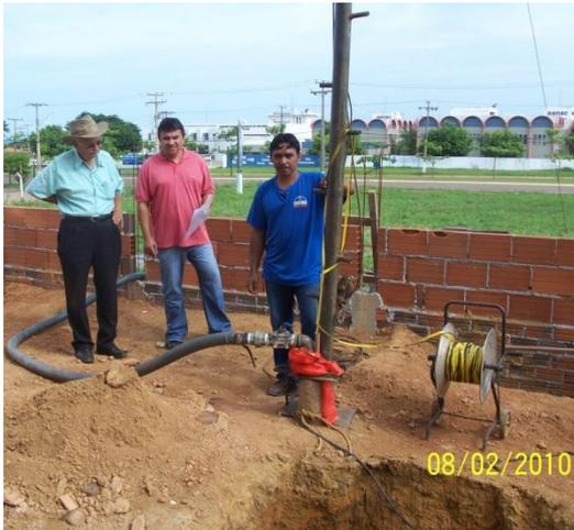
Figura 12.2 – Teste expedito para dimensionar a bomba a utilizar
