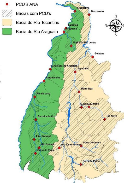
As Plataformas de Coleta de Dados – PCD's, produzem e transmitem dados de chuvas, nível dos rios e vazão, em tempo real, via satélite até os servidores da Agência Nacional de Águas – ANA, sendo disponibilizados via web e processados pelos técnicos da Sala de Situação.
