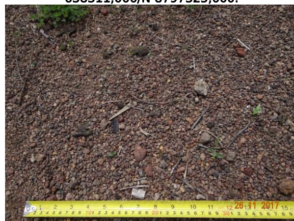
Figura 15: Cascalho laterítico abundante verificado na superfície da Jazida 02, Estaca 213 (LE), Coord. UTM 22L SIRGAS 2000 E-638115,000/N-8796770,000.
