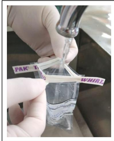
Figura 08. Coleta da Amostra de água na bolsa plástica
