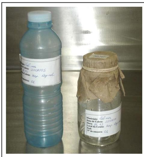
Figura 01. Frascos para coleta organoléptica (à esquerda) e microbiológica (à direita).
