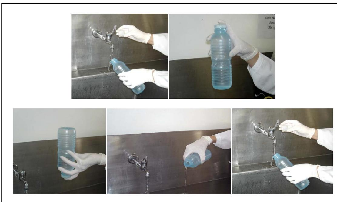
Figura 11. Procedimento de coleta de água para a análise organoléptica
