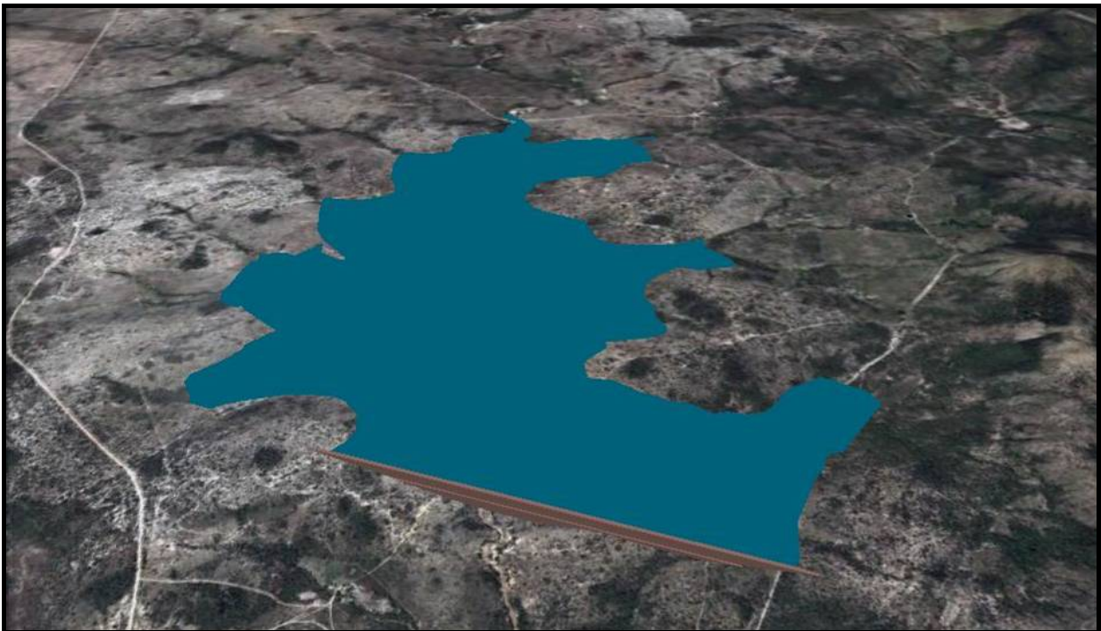
FIGURA 3.5.2.2 – Projeção da primeira fase de implantação da barragem de rejeitos (primeiros três anos de operação) sobre o modelo do terreno.
