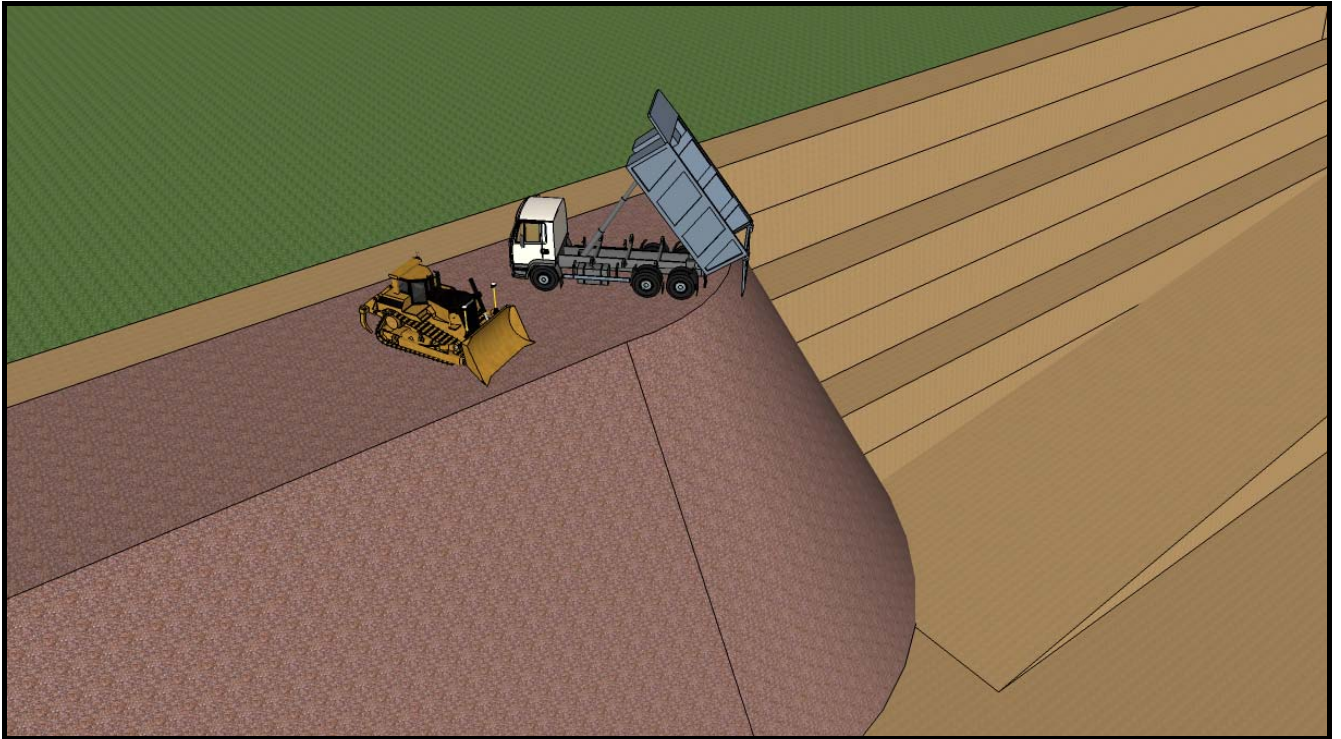
FIGURA 3.3.3.5 – Ilustração da operação de disposição de material estéril em sobre as áreas de lavra exauridas para a recuperação da topografia do terreno.
