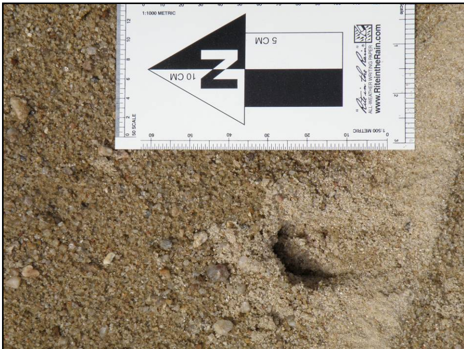
FOTO 4.2.5.21 – Detalhe da foto anterior na qual é possível observar a granulometria fina da areia, denotando a grande capacidade, porém baixa competência neste trecho do canal. Estes bancos de areia são muito comuns e dinâmicos, pois a cada cheia o rio, por sua força hidráulica, ele remobiliza e transporta grande quantidade de sedimentos, alterando sempre a localização e granulometria.
