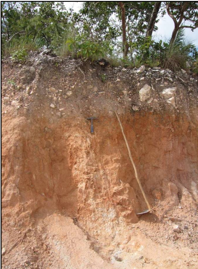
FOTO 4.2.5.9 – Vista do Perfil denominado 05 caracterizado como Plintossolo Pétrico. Observar os horizontes característicos, com presença horizonte com presença de cascalhos e calhaus de quartzitos cimentados. Nos horizontes inferiores a uma gradação de um solo vermelho-amarelo para amarelo claro e cinza, com presença de processo de caulinição, principalmente na região do contato solo-rocha, onde ocorre a pedogênese mais extrema.
