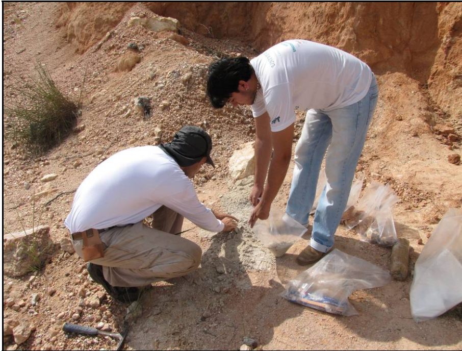
FOTO 4.2.5.14 – Coleta de amostras em campo dos horizontes mapeados para posteriores análises e verificação de dúvidas levantadas quanto a origem e tipo de solo.
