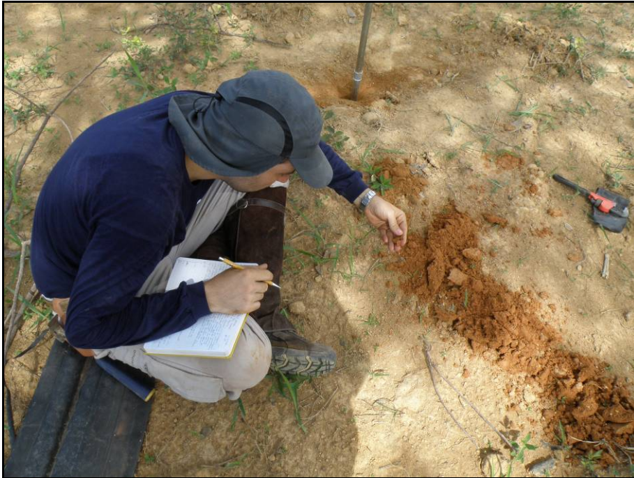
FOTO 4.2.5.18 – Análise e verificação em campo do solo tradado na área do perfil 04. Este solo possui matriz argilosa com presença de cascalhos em toda sua extensão. Observar coloração vermelho-amarelada.
