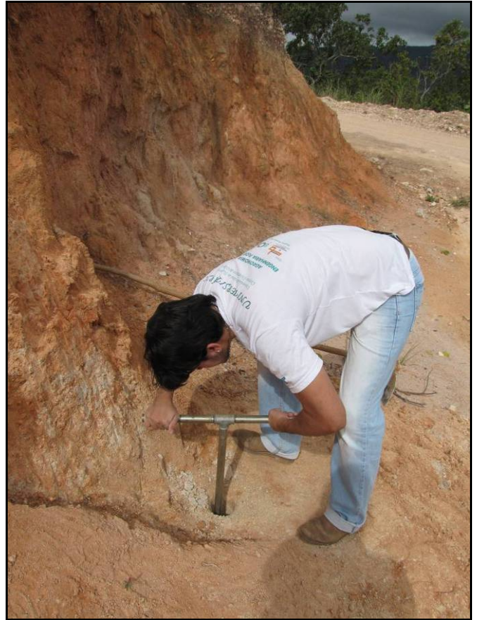
FOTO 4.2.5.10 – Tradagem realizada no perfil 05 para alcançar as camadas subjacentes do perfil pedológico.
