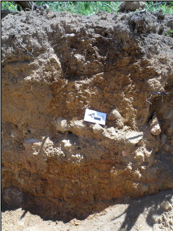
FOTO 4.2.5.7 - Detalhe do perfil 03 com presença de fragmentos de rocha (silexito) caracterizando o perfil neossolo lítico.
