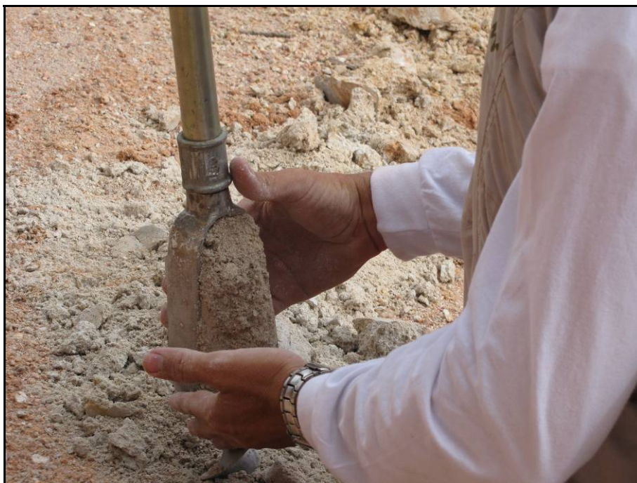
FOTO 4.2.5.13 – Produto da tradagem no perfil 05 com cerca de 4m de profundidade. Notar a presença de um solo argilo-arenoso cinza com presença de caulim.
