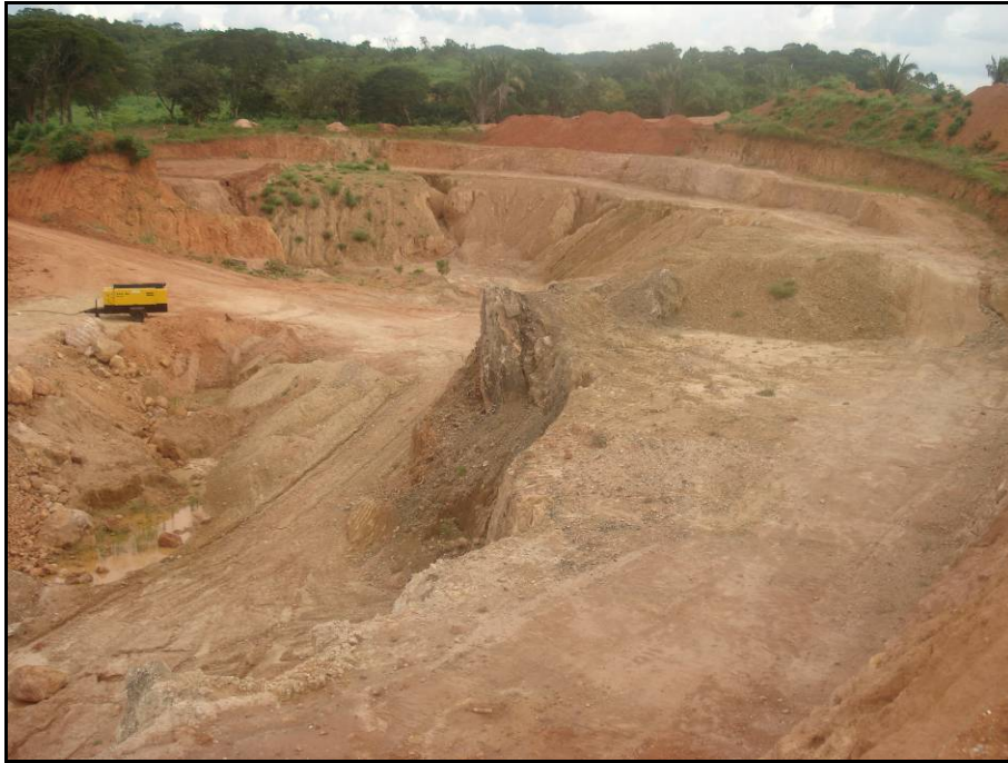
FOTO 4.2.4.33 – Área de extração por meio de Guia de Utilização onde a Itafós extrai o minério fosfático.
